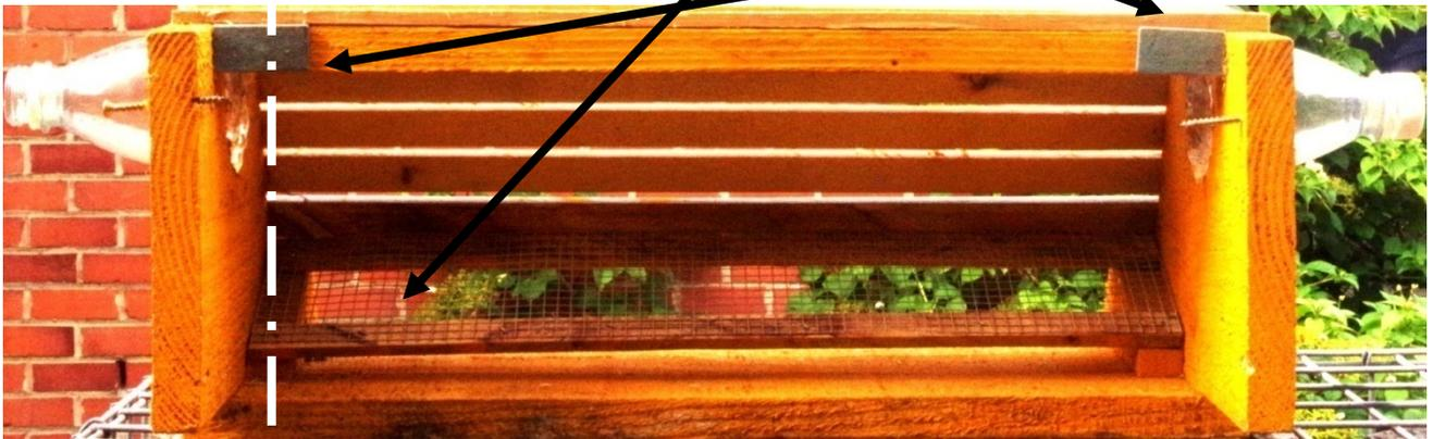
**B** ← épaisseur planches ; 20mm    latte raidisseur 20x20mm longueur= largeur DB 10c
