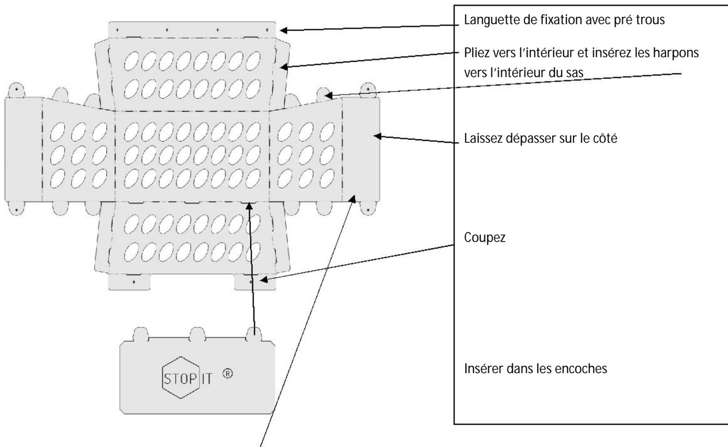
Mesurez votre plancher de ruche et découpez selon les dimensions afin que le plancher du sas repose sur la planche d'envol
