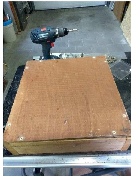
Suite assemblage corps avec couvercle et fond en grille à reine et espace entre la grille du haut et le couvercle pour laisser les autres insectes sortir. Grille fine maille pour interdire l'accès au compartiment appât. Glissières récupérées dans des lames de plancher.
